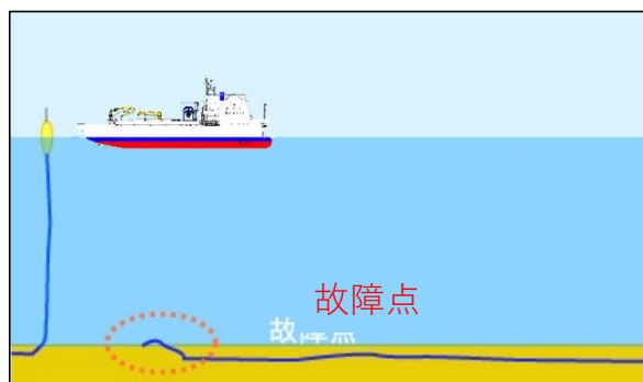
③ケーブルを試験し、良好なことを確認したら、先端に防水措置を施し浮標（ブイ）を設置
